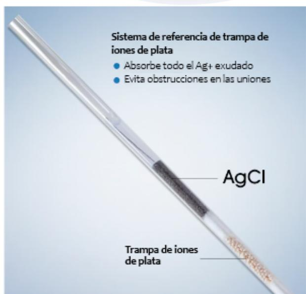
La combinación de un sistema de referencia de larga duración y una trampa de iones de plata. La trampa de iones de plata absorberá todo el Ag<sup>+</sup> exudado, lo que garantiza que no haya Ag<sup>+</sup> en el electrolito de referencia y evita obstrucciones en las uniones causadas por muestras que contienen sulfuros, proteínas o soluciones tampón TRIS.
