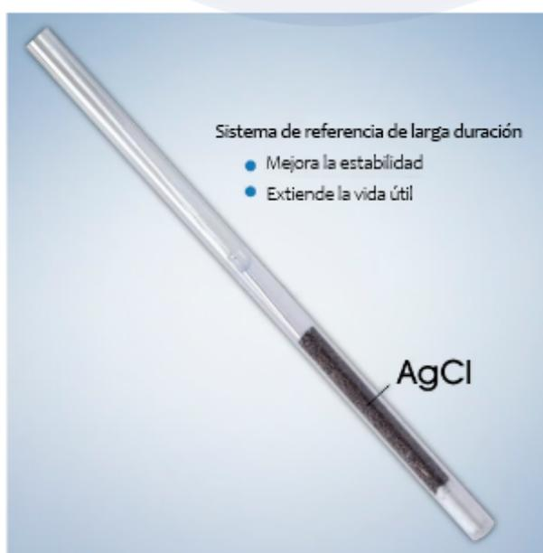
Compuesto por un tubo de vidrio, AgCl y un alambre de plata de referencia. El extremo superior del delgado tubo de vidrio está relleno de algodón, lo que evita la reacción entre AgCl y el electrolito cuando cambia la temperatura. Mejora la estabilidad del sistema de referencia y extiende la vida útil del electrodo.
