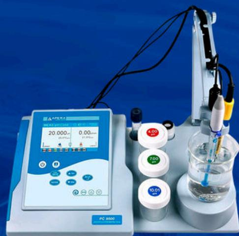
El PC9500 de Apera Instruments es un medidor multiparámetro portátil y preciso, ideal para profesionales que necesitan análisis confiables en campo y laboratorio. Permite medir simultáneamente pH/ORP, conductividad, TDS, salinidad, resistividad y temperatura, integrando múltiples funciones en un solo equipo eficiente y versátil.
