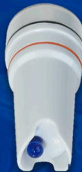
El electrodo PH60-DE de Apera Instruments es el electrodo de repuesto para el medidor de pH inteligente PH60-Z. Este electrodo cuenta con una membrana de bulbo de vidrio de alta sensibilidad, un sensor de temperatura integrado, dos diafragmas y una solución interior de gel azul sin burbujas. Es ideal para la medición del pH de soluciones de agua en general, como hidroponía, acuicultura, piscinas y spas, tratamiento de agua, monitorización ambiental, agua de refrigeración, etc.
